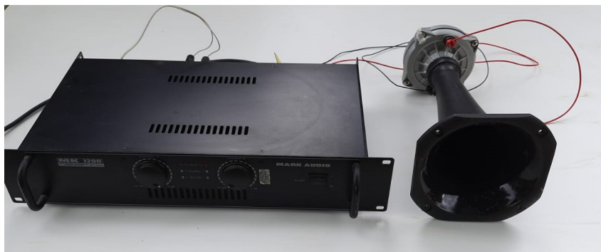
Figura 34 – Conjunto de excitação acústica
